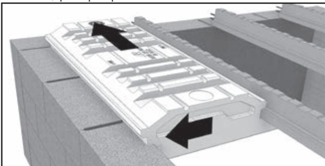
3. **Pose des entrevous :** emboîter les entrevous suivants. En fin de travée, découper si besoin le dernier Rectosten® Nervuré afin d'ajuster sa longueur. Réutiliser la chute sur la travée suivante.
