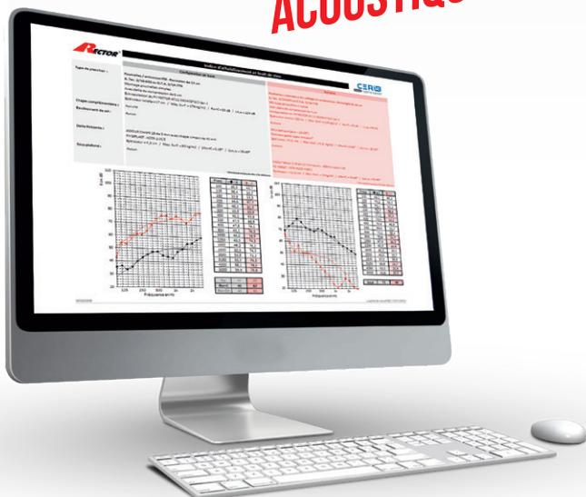
Le spectre acoustique permet d'évaluer l'indice d'affaiblissement  $R_w$  (C;Ctr) et le niveau de bruit de choc  $L_{nw}$  de la paroi plancher (revêtement de sol et faux plafond compris).
