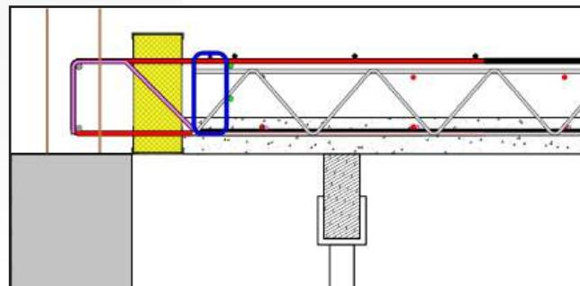
La pose de la Thermoprédale BA 0,2 nécessite la mise en place de files d'étalement. Leurs emplacements sont matérialisés sur le plan de pose.
