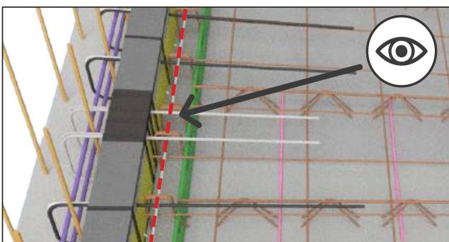
Un contrôle visuel du bon alignement des rupteurs doit être réalisé.
