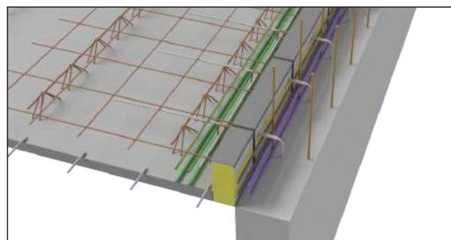
Après la mise en place de la Thermoprédale BA 0,2, les armatures filantes des chaînages internes et externes peuvent être mises en place sans manipulation complémentaire.
