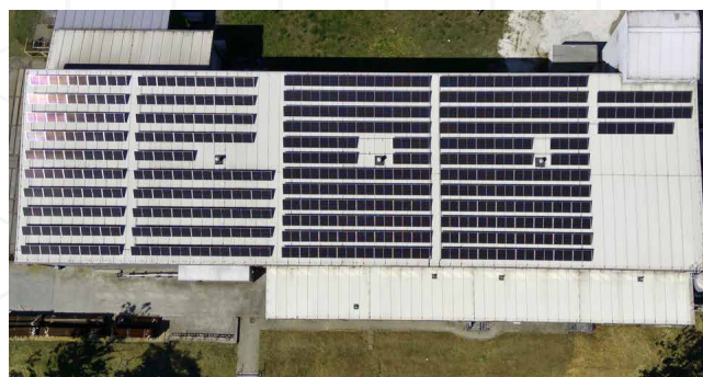
Site de Chrzanów – Panneaux photovoltaïques en toiture d'une puissance de 50 kWc (autoconsommation)
