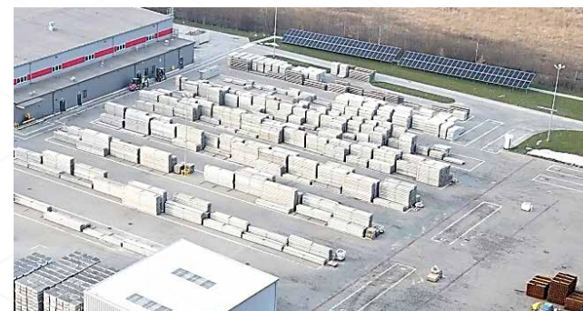
Site de Mszczonów – Panneaux photovoltaïques au sol d'une puissance de 50 kWc (autoconsommation)
